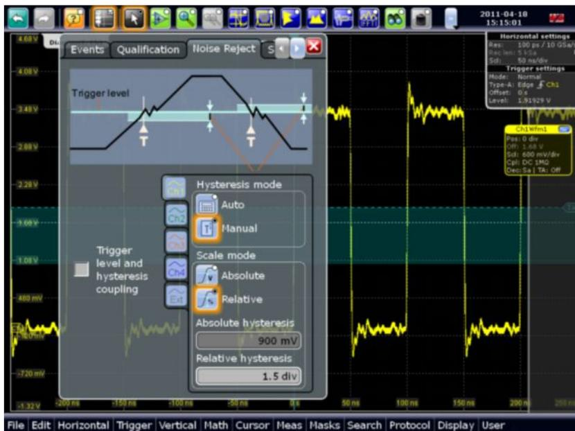
Рисунок 10 – Гистерезис порога запуска RTO свободно программируется. Для наивысшей чувствительности задается нулевой гистерезис.
